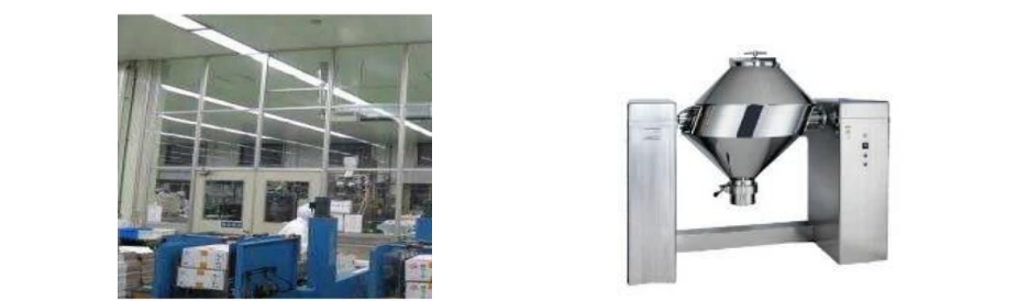
空気を經由した汚染を防止する設備（パーティション）の導入 製造ラインにおいて添加物混入を回避する輸出専用ミキサーの導入
