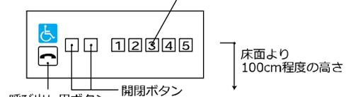
▲ 主操作盤、副操作盤の行き先ボタンは、ボタンを操作することにより、戸の開放時間が通常より長くなる機能を有することが望まれます。
