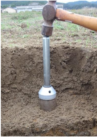
ハンマーで採土管を打ち込む
