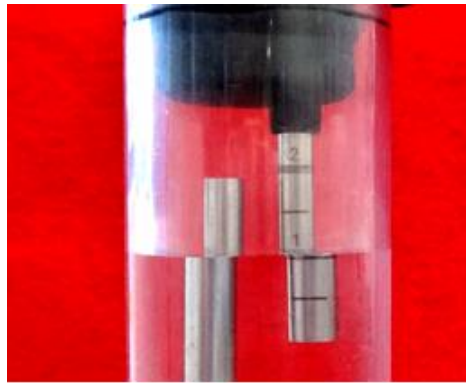
圧力水頭調節チューブの目盛「1」のラインを水面に合わせた様子
