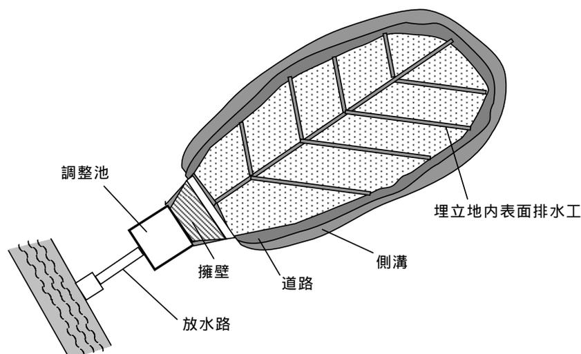
図 4-9 開渠その他の設備の概念
