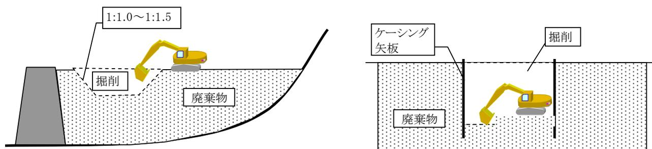
図 4-3 オープン掘削方法(左図)及び土留め工併用掘削(右図)の模式図
