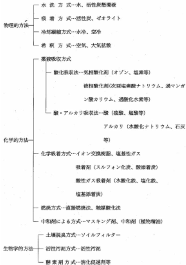
図 4-5 脱臭及び臭気の発散方式の分類<sup>\*3</sup>
