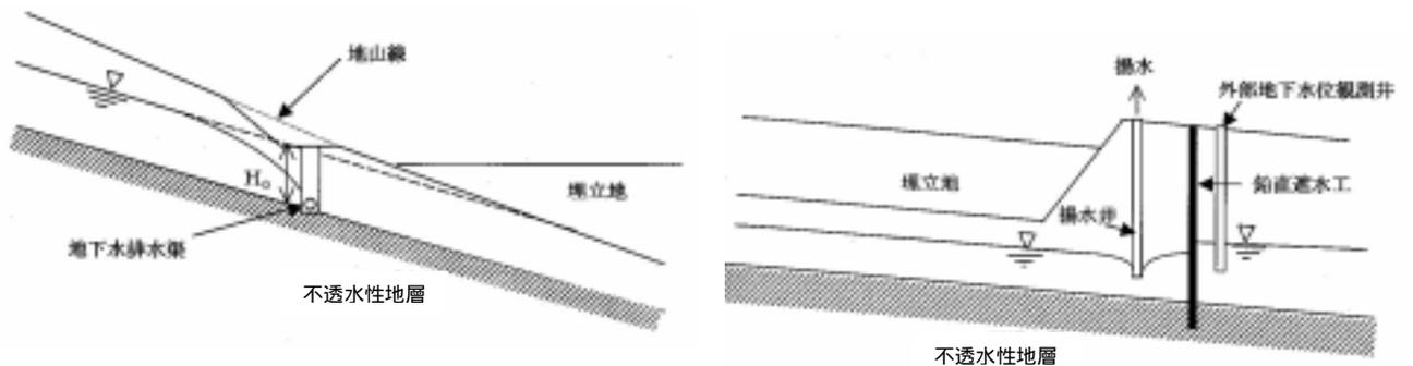
図 4-18 揚水による廃棄物埋立地上流部の地下水流入防止（左図）と鉛直遮水工と揚水井による汚染地下水の外部拡散防止（右図）の例 <sup>\*5</sup>
