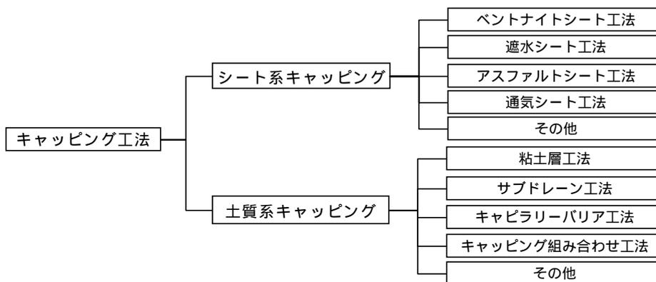
図 4-8 キャッピング工法の分類 <sup>5)</sup>
