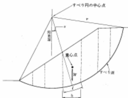
図 4-2 円弧すべり面を用いた常時の安定計算法<sup>2)</sup>
