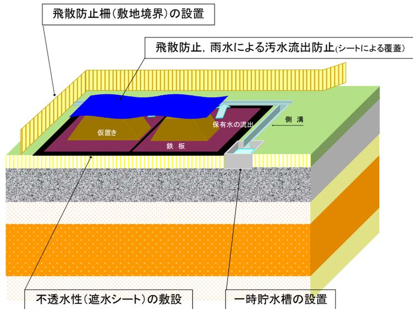
図 4-16 掘削廃棄物等の飛散防止の概念
