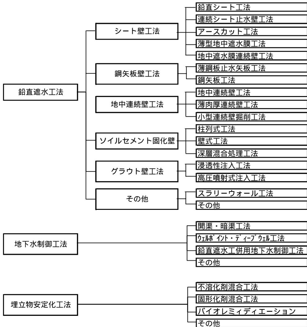
図 4-17 地下水汚染拡散防止工法の種類 <sup>\*5</sup>
