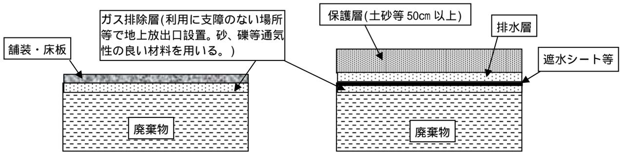
図 4-7 覆土の代替措置の概要
