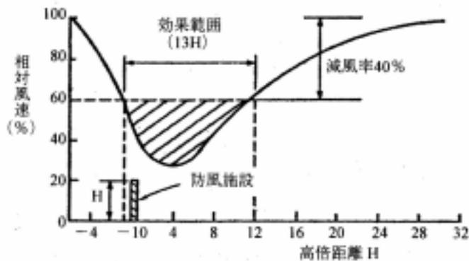
図 4-1 相対風速の水平分布（模式図）<sup>1)</sup>
