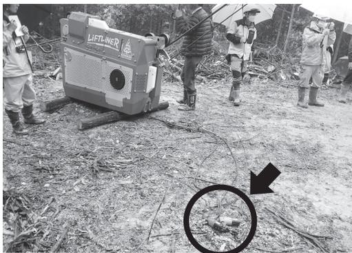
タワーヤードの搬器ワイヤーに取り付けられたオートチョーカー（写真手前）
