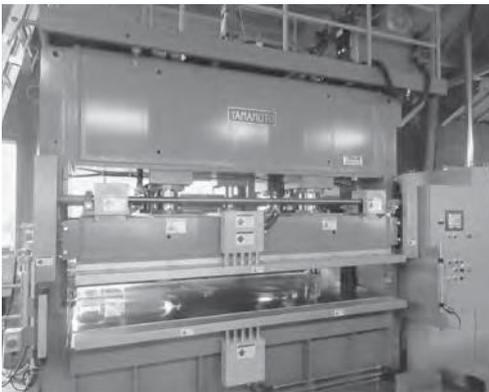
熱圧処理条件等の解明に用いる熱圧処理装置
