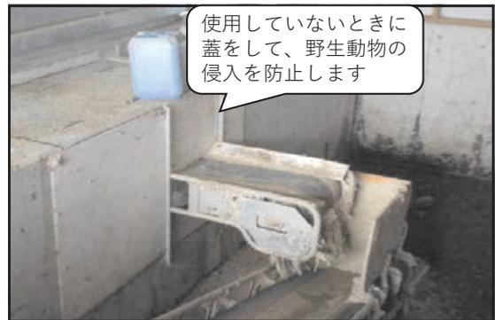
除糞ベルトの搬出口に蓋を設置
