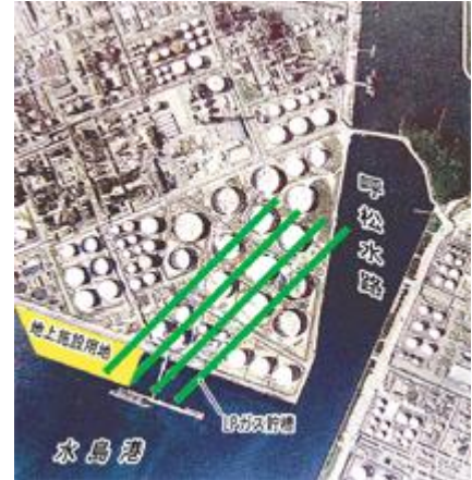
【写真説明】 空から見たLPG備蓄・倉敷基地の建設地 （4本線が地下貯蔵タンク） <山陽新聞社提供>
