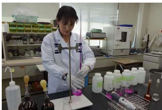
浴槽水の検査(滴定)
