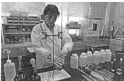
浴槽水検査(滴定)
