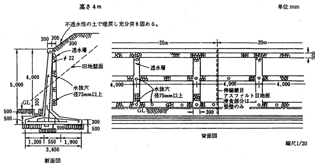
擁壁の断面図 (背面図)
