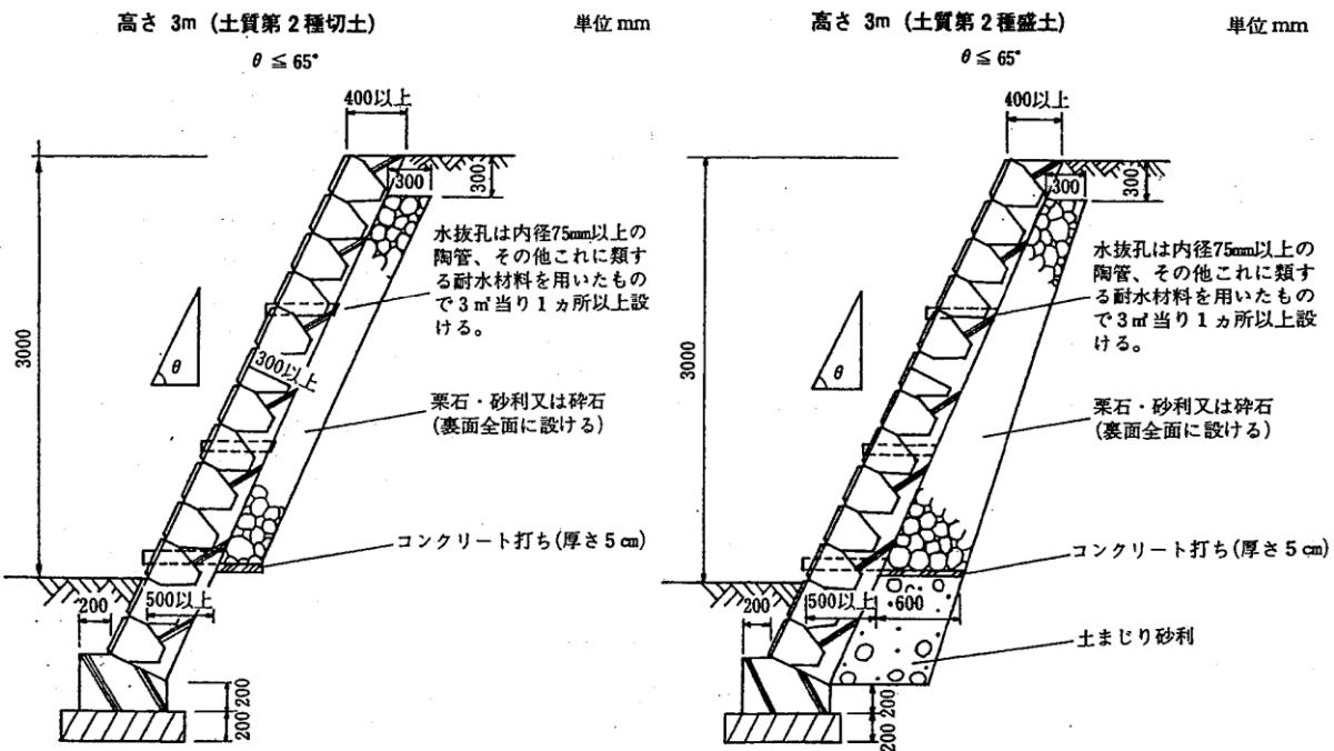
擁壁の断面図 (背面図)
