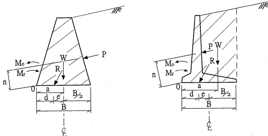
**$M_o$** : 転倒モーメント (擁壁が土圧等によって擁壁基礎底面の前端を中心に回転しようとする作用モーメント)
