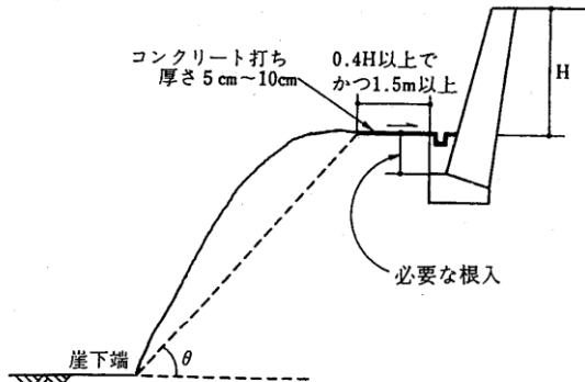
二 擁壁上に擁壁を設置する場合には、図2のように擁壁基礎前端より擁壁の高さの0.4H以上で、かつ、1.5m以上表の土質による角度( $\theta$ )より後退しなければならない。なお、表の土質による角度( $\theta$ )内に入っていないものは、二段の擁壁とみなされるので一体の擁壁として設計を行うこと。
