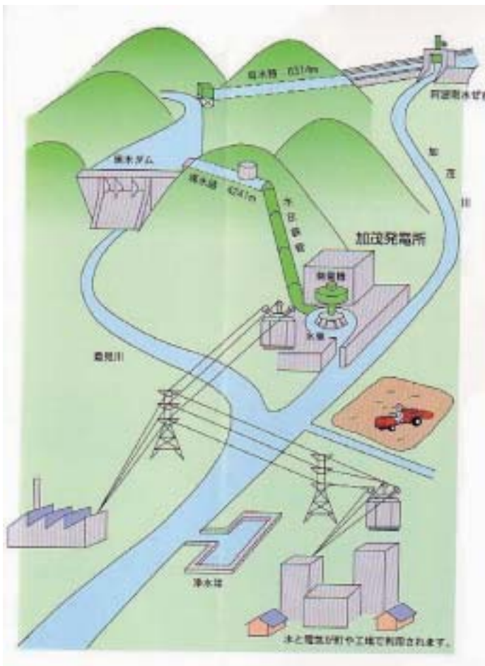
黒木ダムと発電の仕組み
