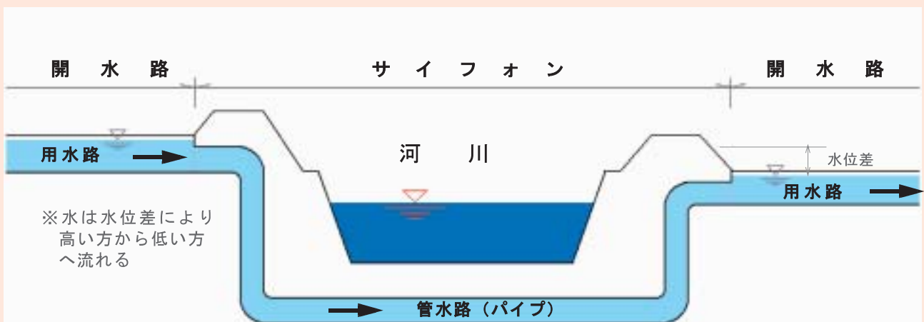
管水路が河川を横断する場合の断面図
