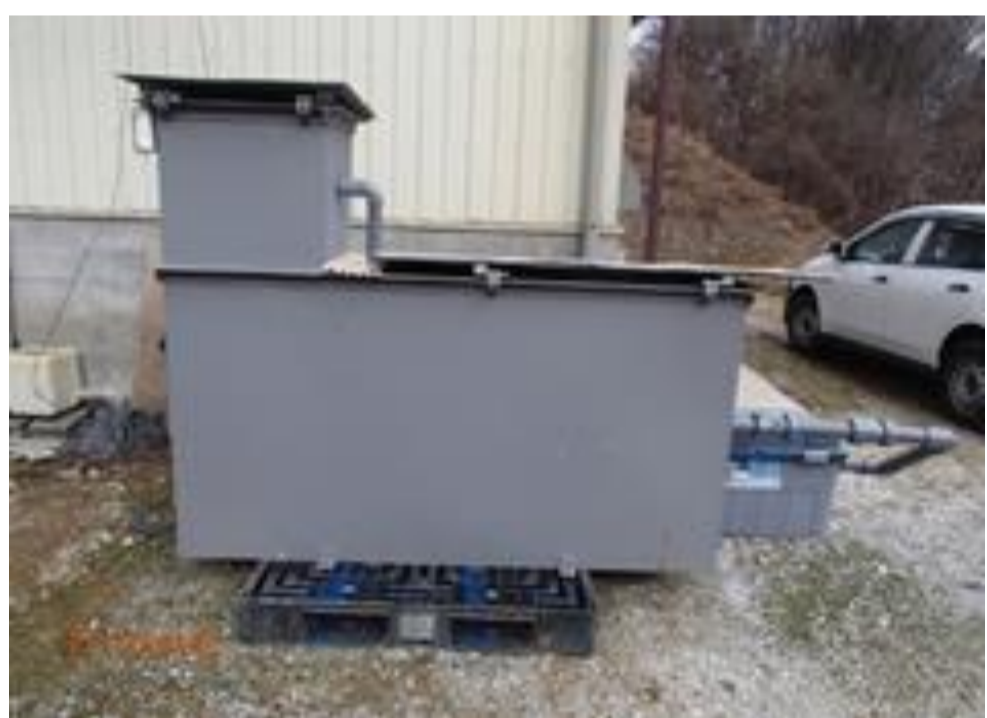
小型試験装置（1.0m 3 の装置に粉末硫黄を入れ浄化処理水を投入）
