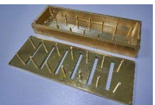
図1: マイクロ波を利用した次世代融雪システム用導波管型漏れ波アンテナ
