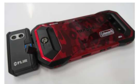
スマホに外部接続するサーモカメラ
