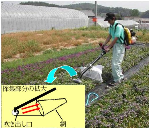
図1 採集装置の構造と採集状況
