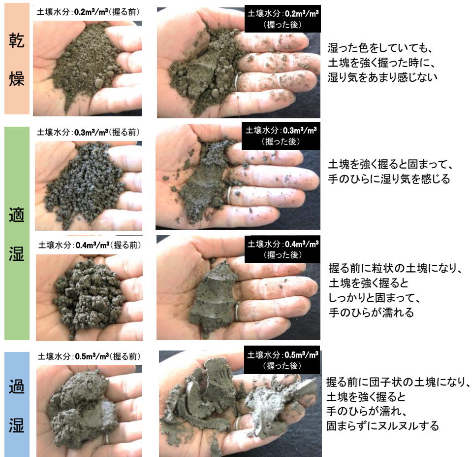
図1 土壌の「見た目」及び「握った感触」による適湿範囲の判定（埴壤土）
