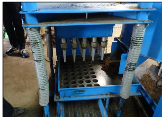
図-11 コンテナ苗用培地圧注機
