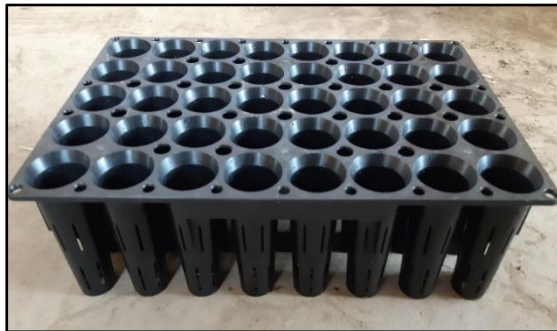
図－2 サイドスリット方式（縦 30cm×横 40cm 150ml キャビティ 40 個連結）
