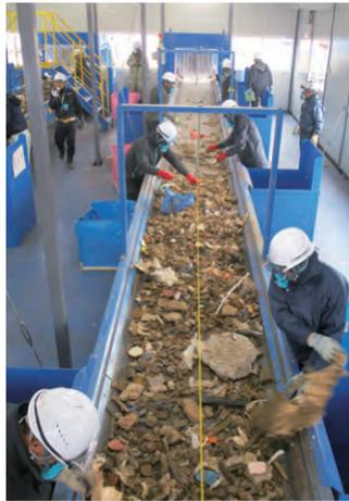
中間処理施設での処理状況 (手選別処理)
