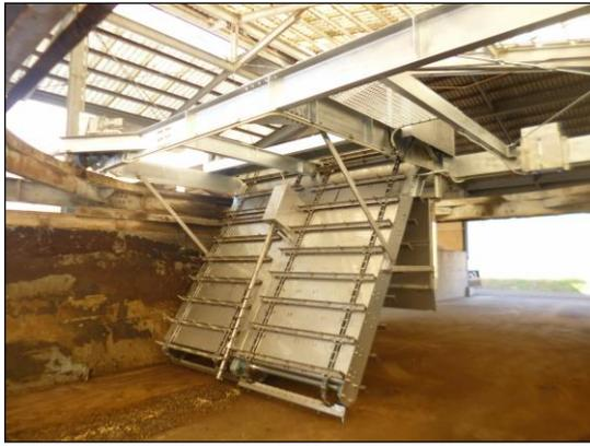
写真2. 機能強化された攪拌装置
