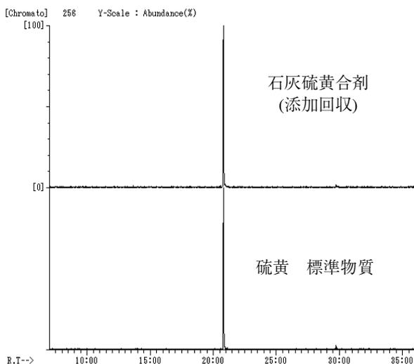
図1 石灰硫黄合剤(添加回収)と標準品のクロマトグラム
