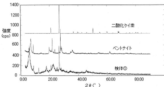
図4 X線回折装置測定結果（有機物分解処理前）
