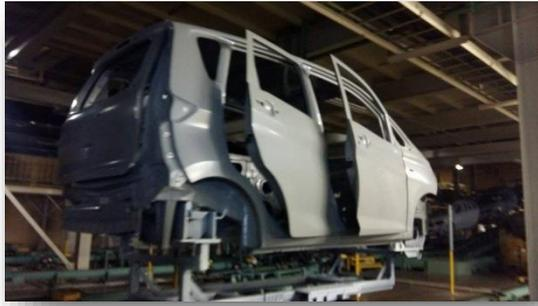
写真 8 下処理を終えて本塗りの工程に入る自動車
