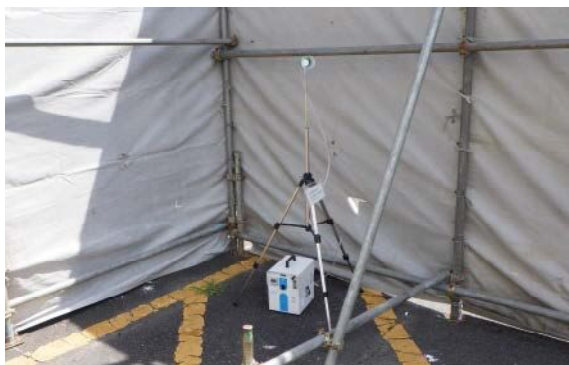
(解体工事現場でのアスベスト測定)
