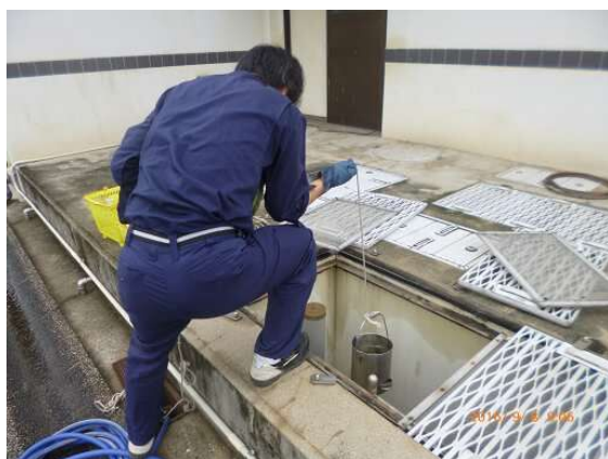
(排水水の行政検査 放流槽での採水)
