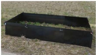
炭化器：鉄板6枚を長方形に重ね、クランプで固定。
