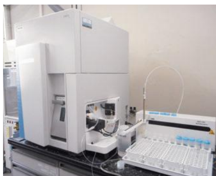
水中のウランを測定する 誘導結合プラズマ質量分析装置 (ICP-MS)
