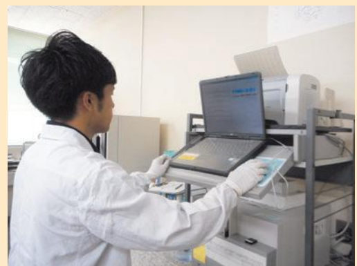
空間ガンマ線線量率を測定する蛍光ガラス線量計（RPLD素子）の測定
