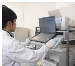
空間ガンマ線を測定する 蛍光ガラス線量計の測定装置
