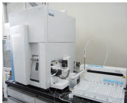
水中のウランを測定する 高周波誘導結合プラズマ質量分析装置(ICP-MS)
