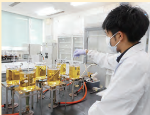
ラジウム分析の前処理作業
