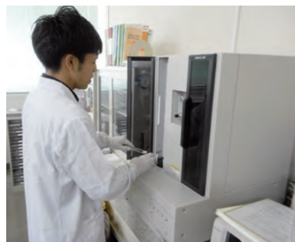
ラジウムを測定するアルファ線自動測定装置
