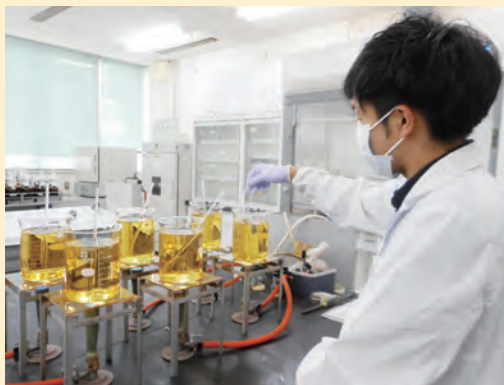
ラジウム分析の前処理作業
