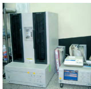
ラジウムを測定する アルファ線自動測定装置
