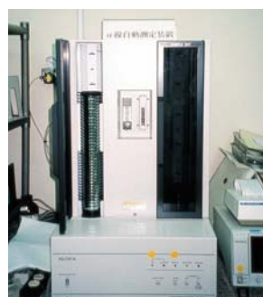
ラジウムを測定する アルファ線自動測定装置
