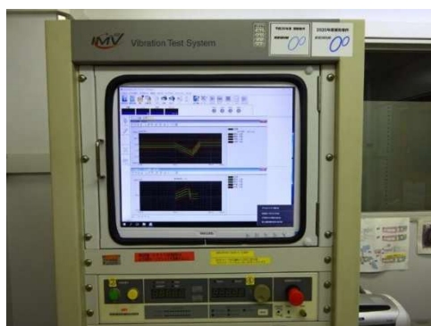
(a) 制御装置（導入装置）
