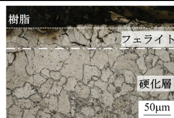
図4. 800℃-10時間で浸窒焼入れしたSPCCの表面近傍の拡大断面組織
