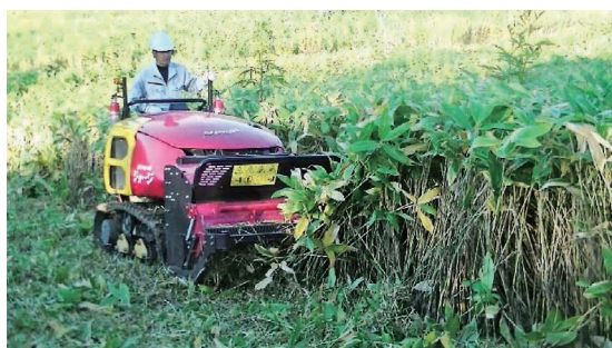
写真2 自走式刈払い機による地拵え作業の様子 （左）乗用型（枝幸町）、（右）歩行型（上ノ国町）
