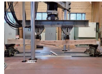
写真3 曲げ試験の実施状況
