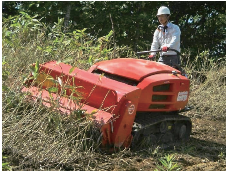
写真1 乗用型刈払い機 (CG431) (ブッシュカッタージョージ) 長さ:3.5m、幅:1.7m、高さ:1.4m 質量:2t
