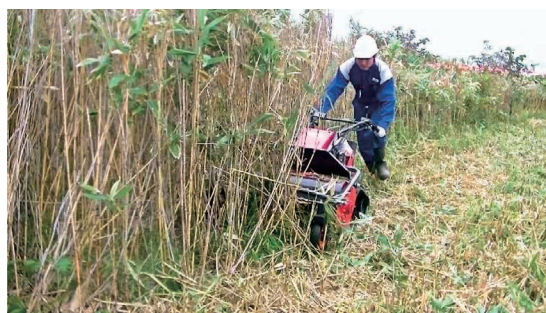
写真2 自走式刈払い機による地拵え作業の様子 （左）乗用型（枝幸町）、（右）歩行型（上ノ国町）
