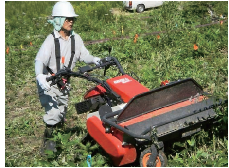
写真2 歩行型刈払い機 (CG101) (ブッシュカッタージョージ Jr.草薙) 長さ:1.8m、幅:1.0m、高さ:1.0m 質量:260kg
