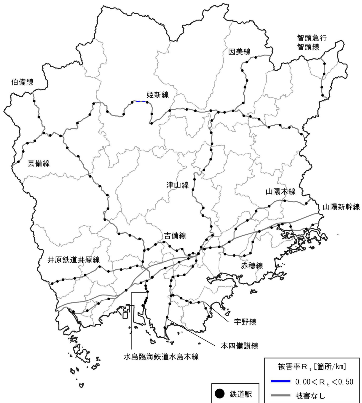
図 8.6.2 鉄道施設被害
