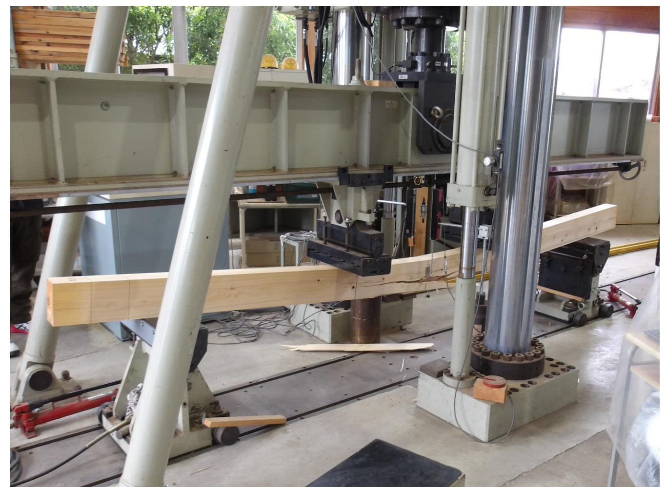
ヒノキ平角材の曲げ強度試験
