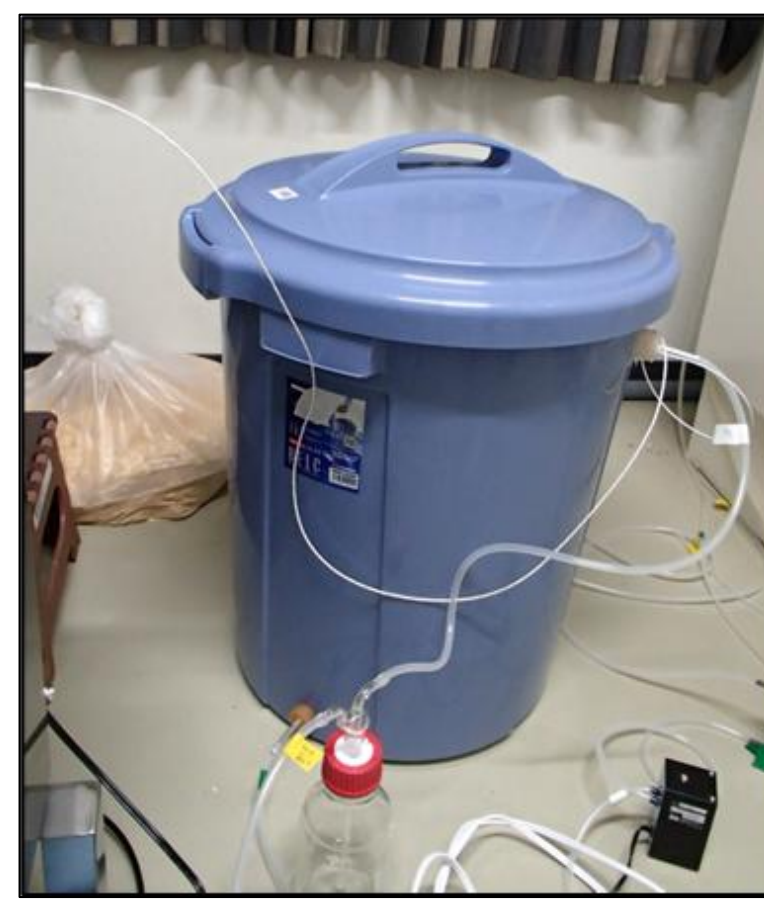
写真1 ペール缶を改造して作成した小型堆肥化試験装置
