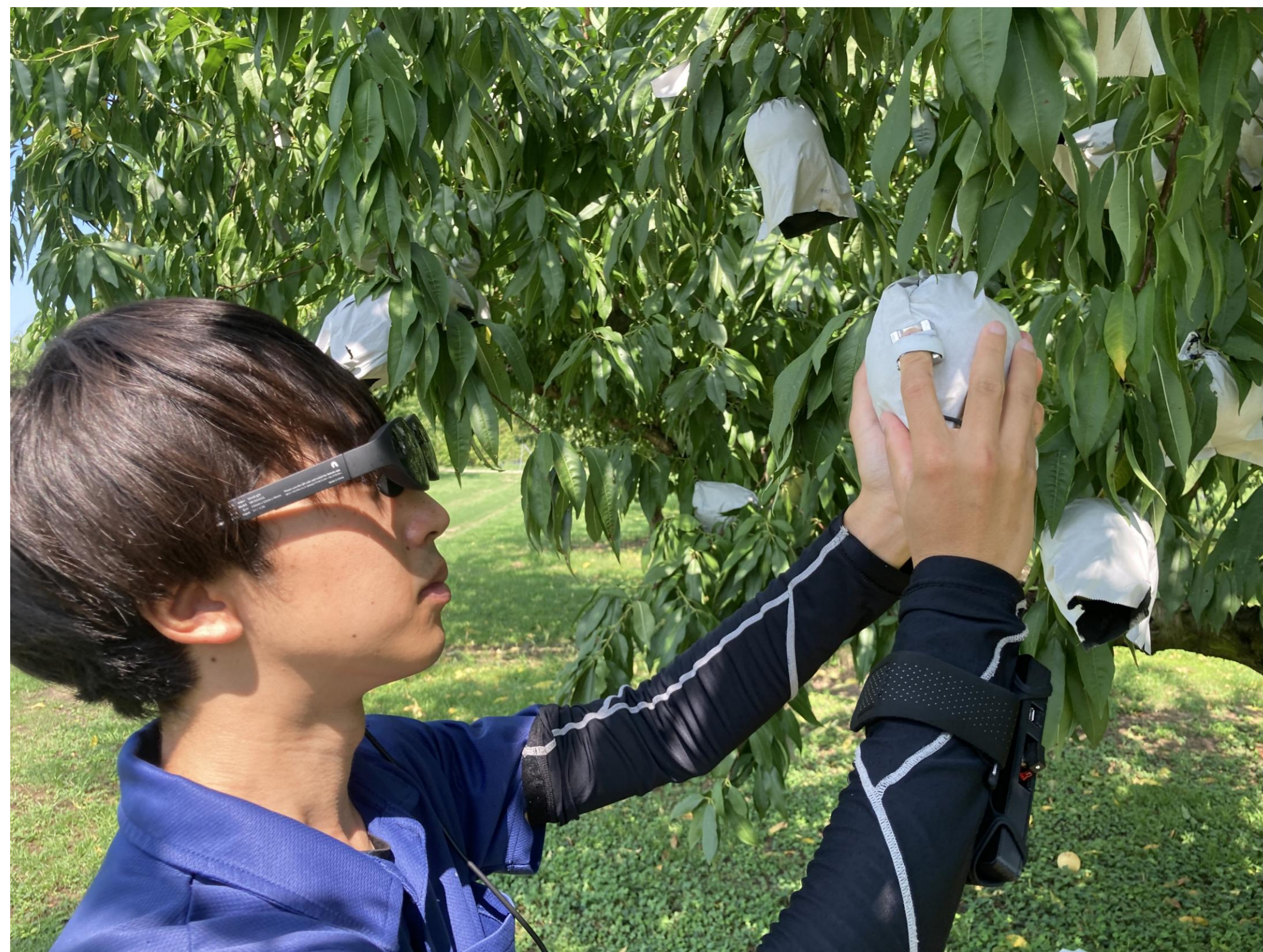
図1 果実硬度共鳴測定器「ゆびけん」による果実硬度の測定の様子
