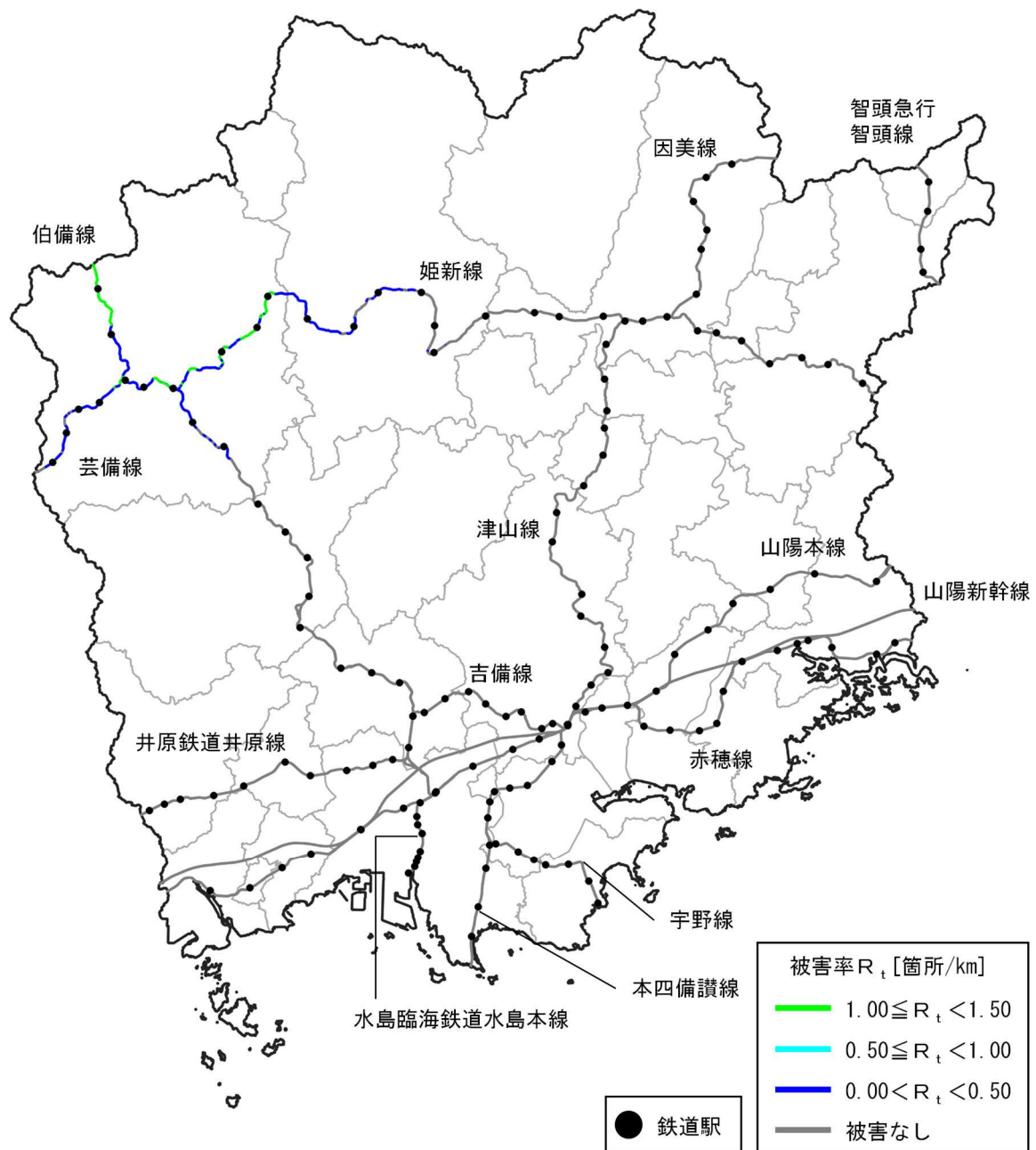
図 9.6.2 鉄道施設被害
