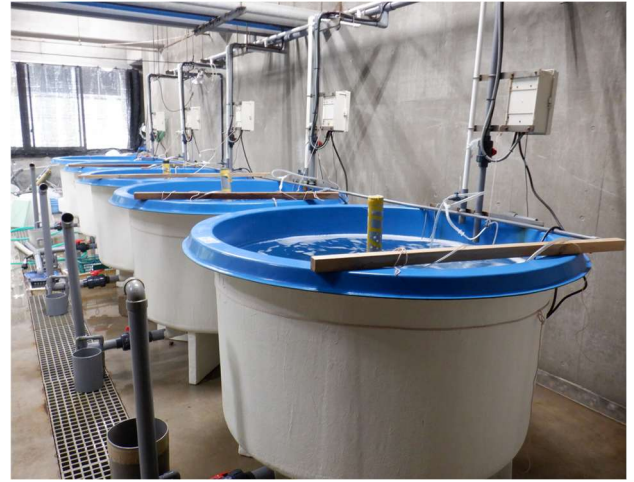
図1 小規模高密度飼育試験水槽(1t 円形水槽)
