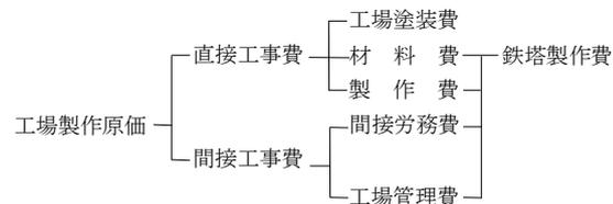
(注) 工場管理費の対象額は直接工事費と間接労務費の和であり、詳細は「第IV編第7章①鋼橋製作工」によるものとする。
