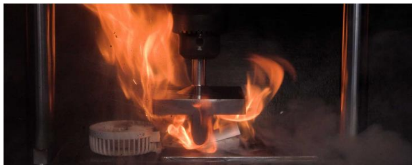
ハンディファンに圧力をかけて発火する様子
