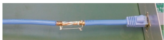
図5 シールド分割部短絡ケーブル
