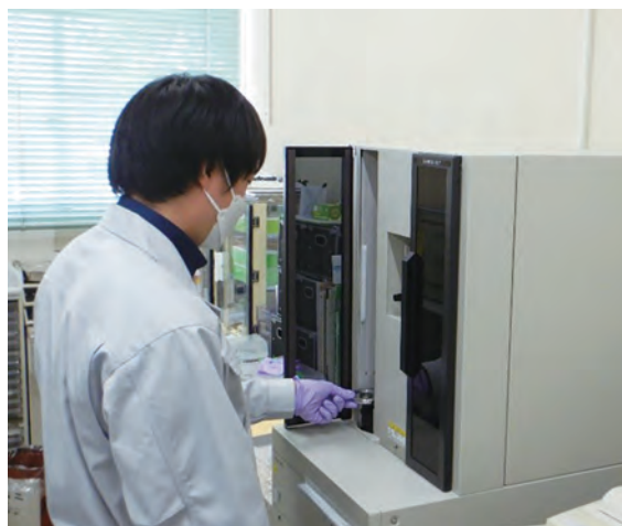
ラジウムを測定する低バックグラウンドアルファ線自動測定装置
