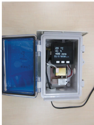
自作可能なCO2モニタリング装置 試作品
