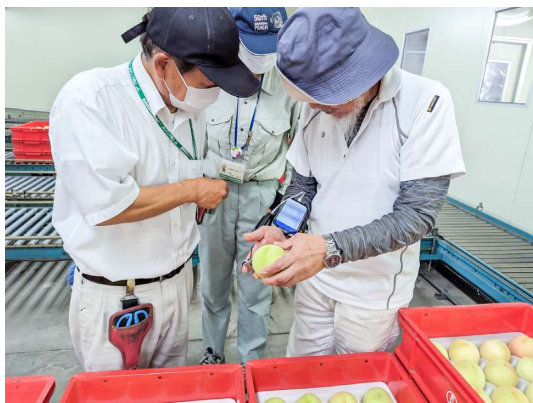
「白皇」の熟度を音響振動装置で測定
