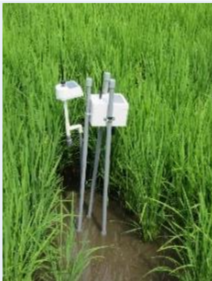
水位計の設置 (令和3年8月)
