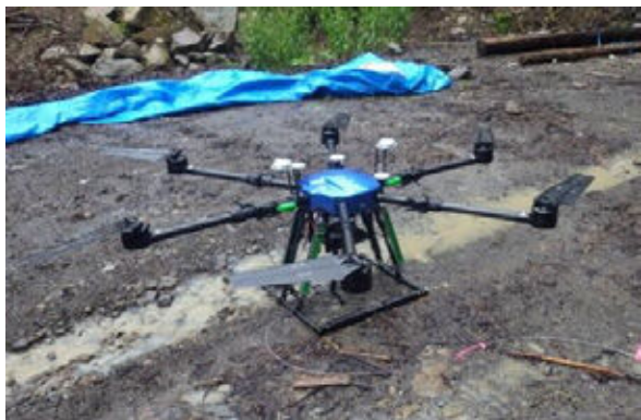
機体：6 枚羽による安定飛行が可能
