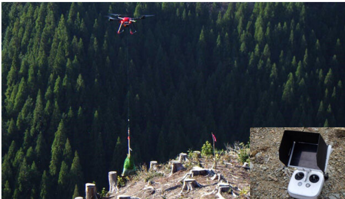
写真 5-8 1オペの機種では発着地点の操縦者がプロポ（右下写真）のカメラ画像を確認しながら、慎重に操縦して運搬物を下降させ、荷下ろしする
