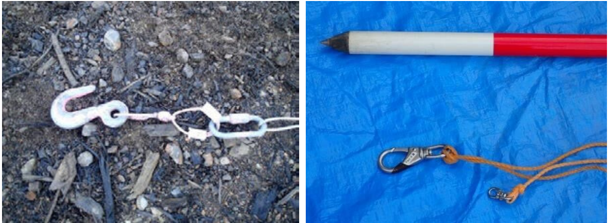
写真 4-4 荷下ろしの際に補助者の手での切離しが必要な簡易フック
