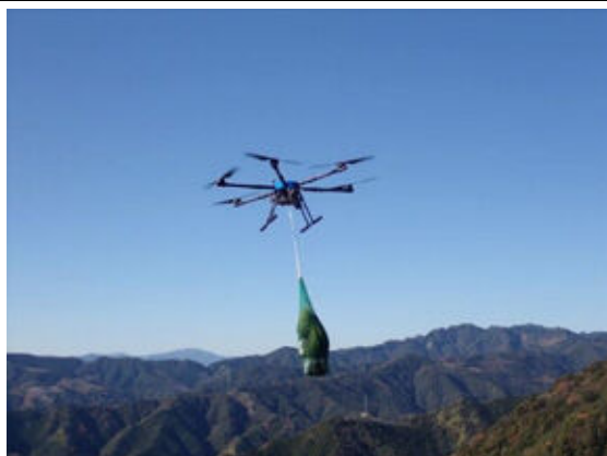
機体：6枚羽で安定した飛行を実現
