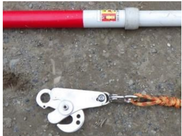
写真 4-3 荷下ろしの際に操縦者の操作で切離しができる自動フック
