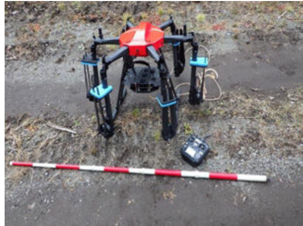
写真 4-1 ドローンのプロペラを広げた状態と閉じた状態
