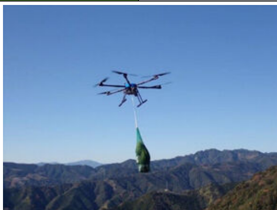
機体：6枚羽で安定した飛行を実現
