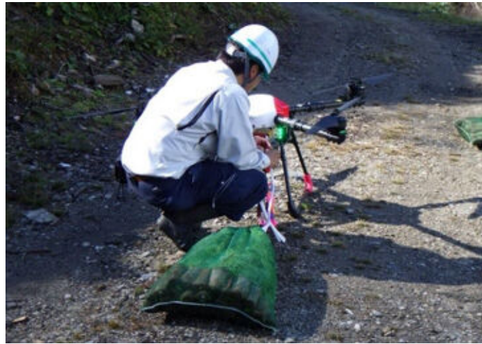
写真 5-6 荷掛作業の様子
