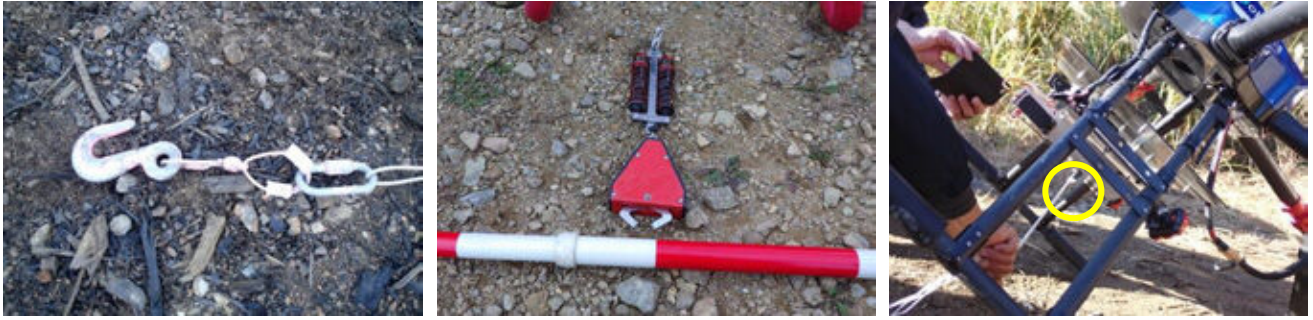
写真 5-4 苗木等を運搬するための簡易フック（左）、自動フック（中）、遠隔切離し装置（右）
