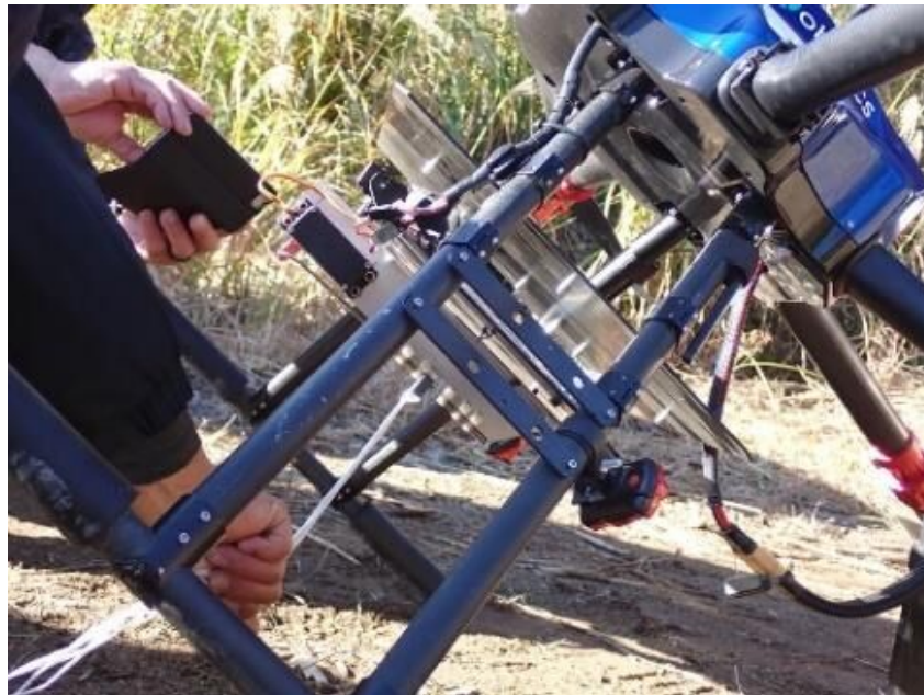
写真 4-5 遠隔操作で運搬物を切り離す機種 (ciDrone/ciRobotics 社)
