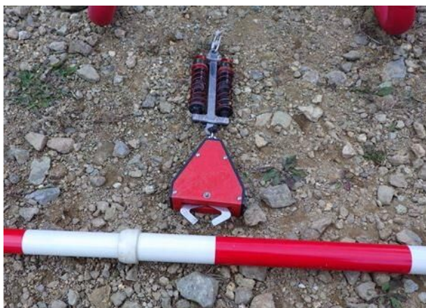
写真 4-3 荷下ろしの際に操縦者の操作で切離しができる自動フック
