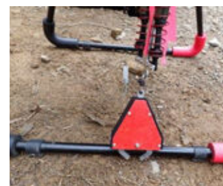
自動フックにより荷下ろしに係る補助者が必要ない
