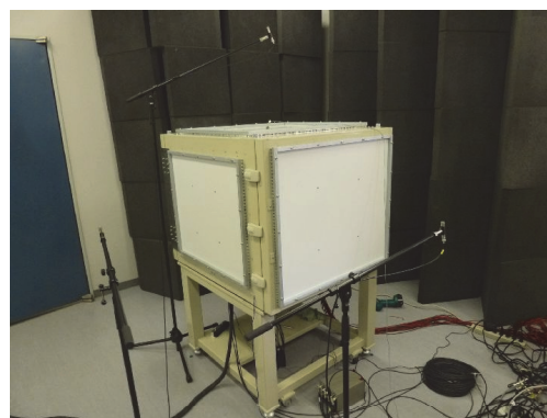
図 2 試作した防音ボックス
