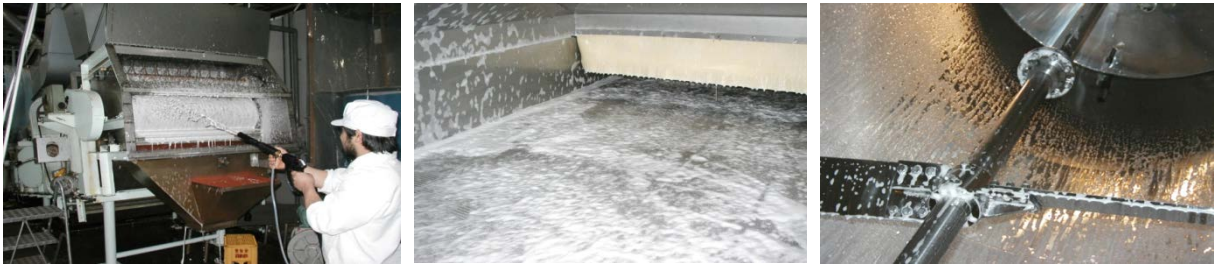
高圧式泡沫洗浄機を用いた酒造機器の洗浄
